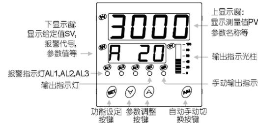
仪表上电后默认进入正常工作状态，此时上显示窗口显示测量值，下显示窗口显示目标值或输出值，同时光柱对应指示输出百分比(有光柱型号)，指示灯依左至右显示为：报警 1 状态、报警 2 状态、报警 3 状态、输出状态、和手动状态。
