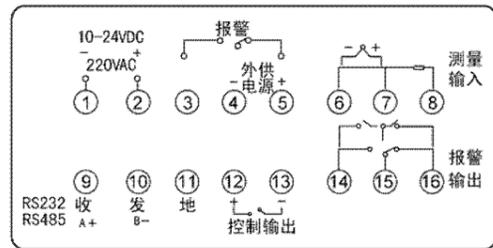
注：③~⑤端子处报警点对应第 2 组报警参数，(14)~(16)端子处报警点对应第 1 或第 1、3 组报警参数
