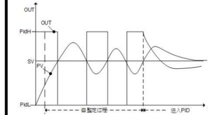
若输出信号为线性电流或电压，可以减小控制周期 CP 至 0.1 以获得更好的控制效果。
