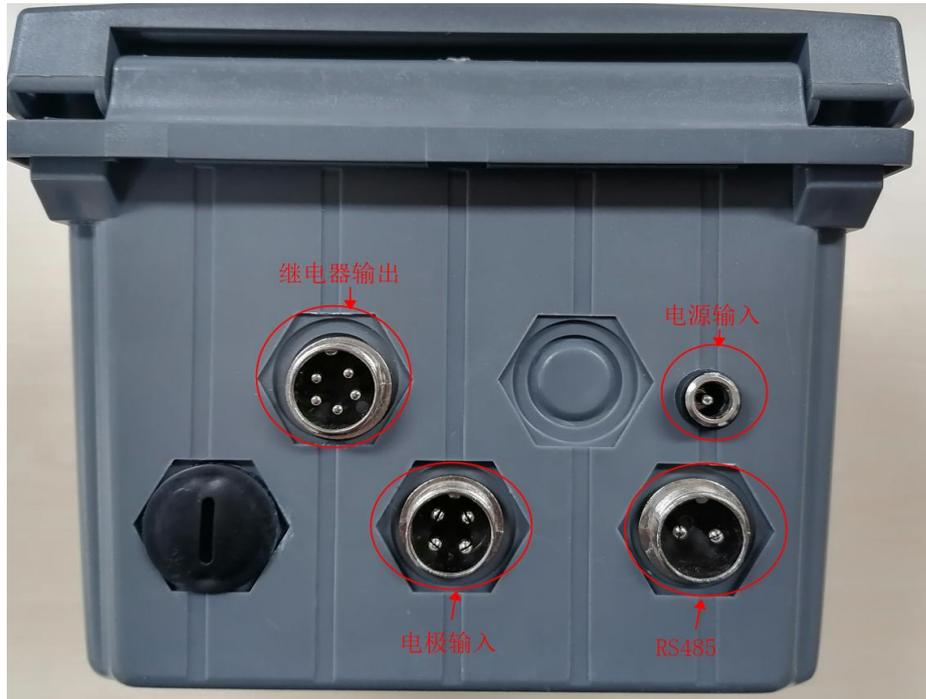
注：继电器输出:航空插头的针脚 1（红）和 2（黑）为高限继电器输出。航空插头的针脚 3（黄）和 4（绿）为低限继电器输出。
